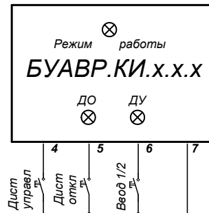
Рис.5 Пример схемы ручного управления АВР с использованием входов дискретного управления БУАВР
