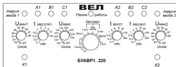
Рис. 2 Расположение органов управления и индикации БУАВР1
